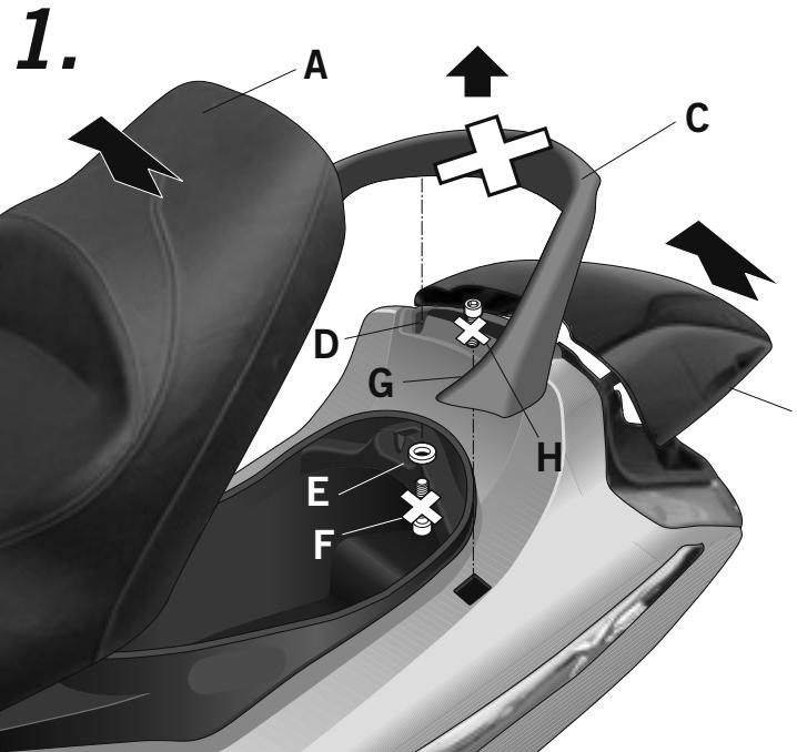
(E) Abrir el asiento (A). Abrir el maletero trasero (B). Desmontar y desestimar el agarradero (C) en zona interior (D) del maletero trasero (B), mediante las arandelas (E) y desestimar los tornillos (F). Y en zona (G), mediante los tornillos (H) que también se desestiman.
